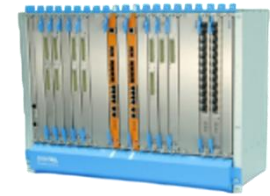
Абонентский цифровой концентратор (MSAN SI3000)
